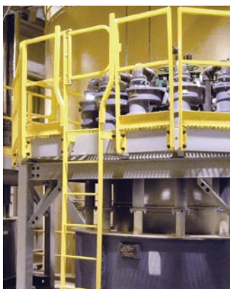
Plataforma elevada con guardarraíl de protección.
